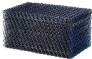
Микроструктура поверхности облегчает смешивание воздуха/воды и увеличивает площадь поверхности для охлаждения. Вложенная конструкция листов улучшает процесс охлаждения и существенно снижает засорение. Этот наполнитель идеально подходит для контротока в приложениях с очень грязной водой и способен выдерживать температуры горячей воды до 75°C (167°F).
